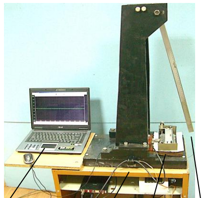
Рис. 5. Установка для визначення ТВКП (без термостата): 1 – комп'ютер; 2 – вимірювальний прилад Handyscope HS; 3 – передпідсилювач; 4 – модуль переміщень зразка; 5 – ударник
