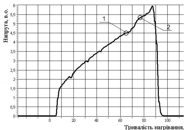
Рис. 6. Діаграма зміни напруги у процесі нагрівання при спіканні системи алмаз–WC/Co: 1 – момент початку плавлення розплаву Co–WC–C алм ; б – момент завершення просочування шару алмазного мікропорошку розплавом Co–WC–C алм
