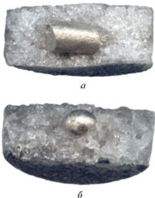
Рис. 4. Зображення зразків нікелю в середовищі CsCl до плавлення в КВТ (а) та після плавлення (б)
