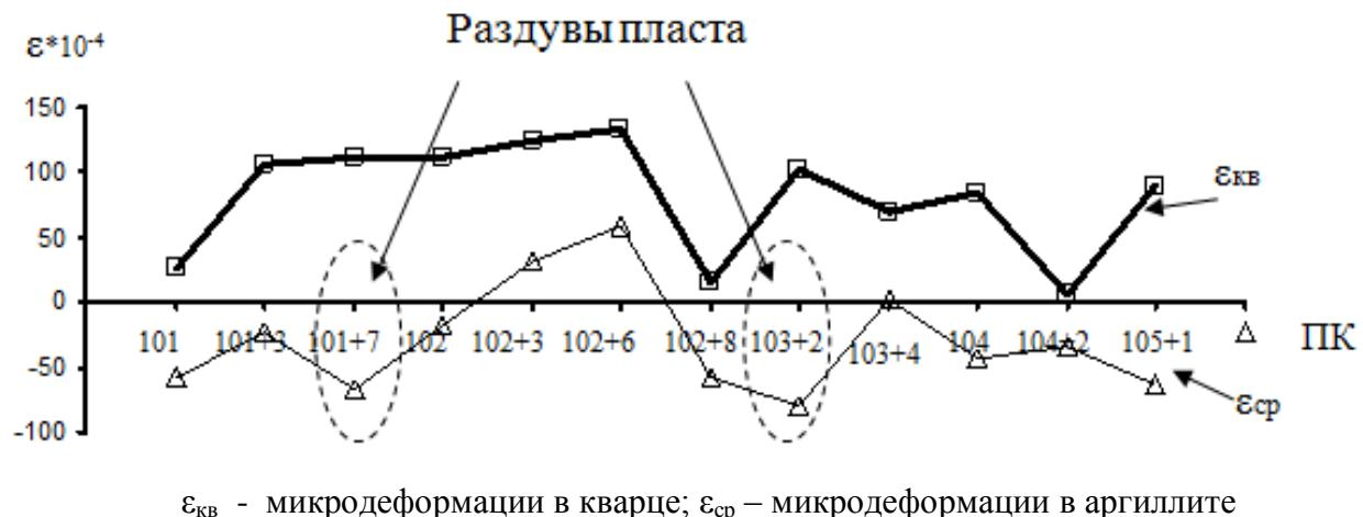
Рисунок 1 – Изменение микродеформаций в аргиллите непосредственной кровли пласта  $h_6'$  по длине 2-го западного конвейерного штрека шахты им. А.А. Скочинского
