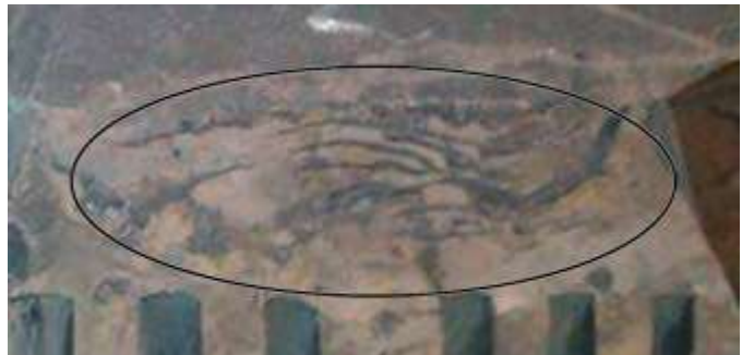
Рисунок 2 – Сліди втомного руйнування гумової решітки вивантаження
