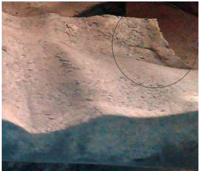
Рисунок 1 – Сліди втомного руйнування гумової футеровки 3 ряд від завантаження
