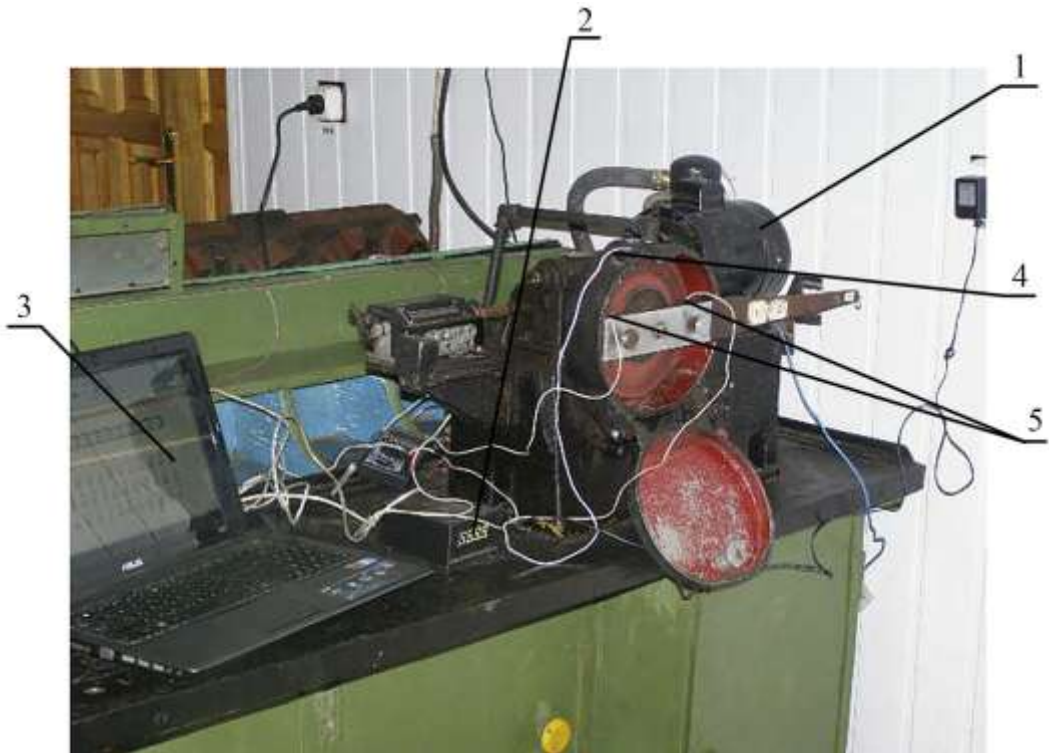
1 – машина тертя МИ-2, 2 – перетворювач, 3 – ПОМ, 4 – індукційний датчик обертів, 5 – термопари
