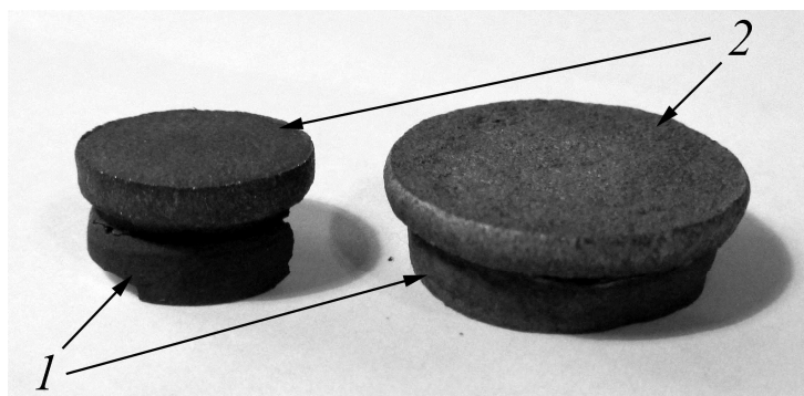
Рис. 4. Реакционный состав ячеек высокого давления АДВ «Тороид-40» (слева) и «Belt-40» (справа) после нагрева под высоким давлением до температуры плавления сплава-растворителя углерода: сплав-растворитель углерода (1) и пропитанный им источник углерода, превратившийся в конгломерат алмазов спонтанного синтеза (2)
