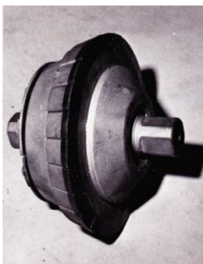
Рис. 3. Внешний вид твердосплавного вращающегося реза
