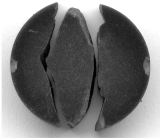
*Рис. 4. Характер разрушения дискового образца композита cBN-25 об. % TiN при динамическом диаметральной сжатии.*
