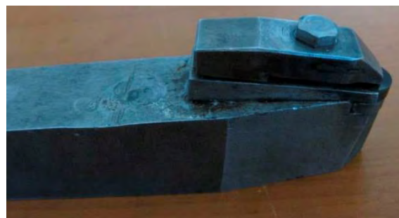
Рис. 4. Загальний вигляд спеціального різця для закріплення дослідного зразка АТП
