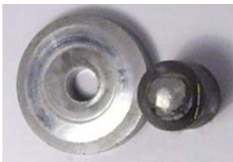
Рис. 2. Характер изнашивания пары трения «твердый сплав – ПСТМ»
