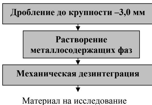
Рис. 4. Подготовка № 1 к обогащению, применяемая в классической комплексной схеме переработки ПС сVN.
