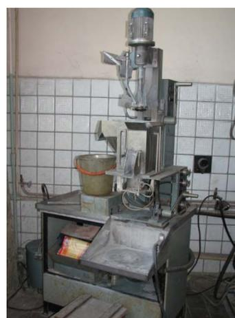
Рис. 3. Флотационная машина.
