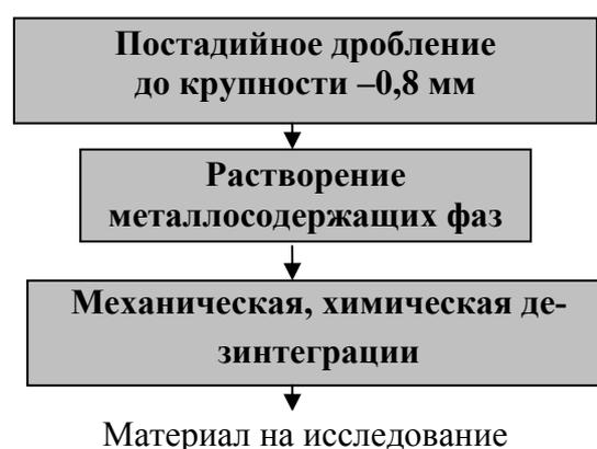
Рис. 5. Подготовка № 2 к обогащению (экспериментальный способ) для применения в комплексной схеме переработки ПС сVN.
