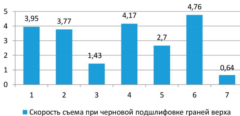
Рис. 5. Диаграмма скорости обработки синтетического кристалла
