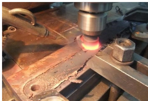
Рис. 5. Общий вид плиты при наплавке
