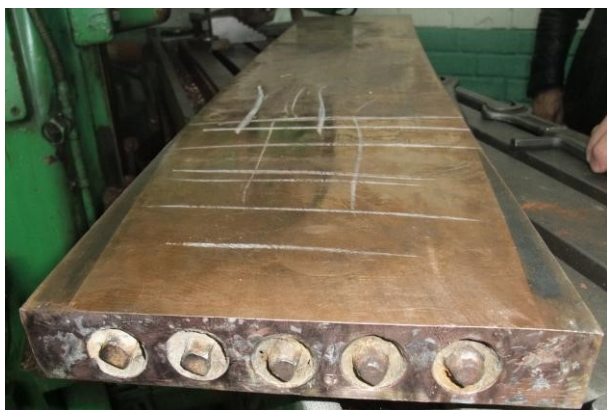
Рис. 1. Общий вид кристаллизатора МНЛЗ после эксплуатации с ярко выраженными клинообразными зонами износа медной плиты
