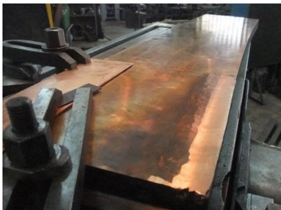
Рис. 6. Общий вид наплавленной и отшлифованной медной плиты (справа); и часть плиты, подготовленная к наплавке (слева)
