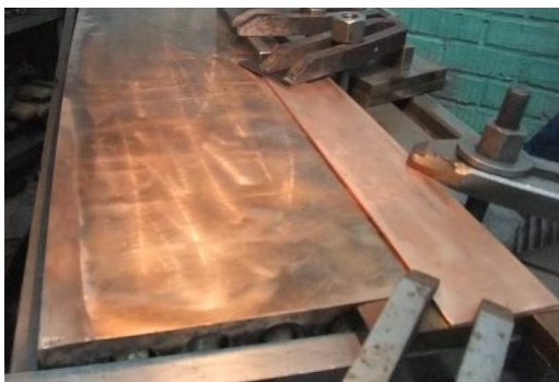
Рис. 4. Общий вид образца собранной плиты с закрепленным на изношенной части медным листом 3 мм перед наплавкой
