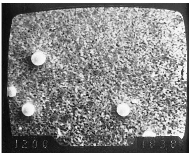
Рис. 1. Микросферы для измерения усадки. ×200
