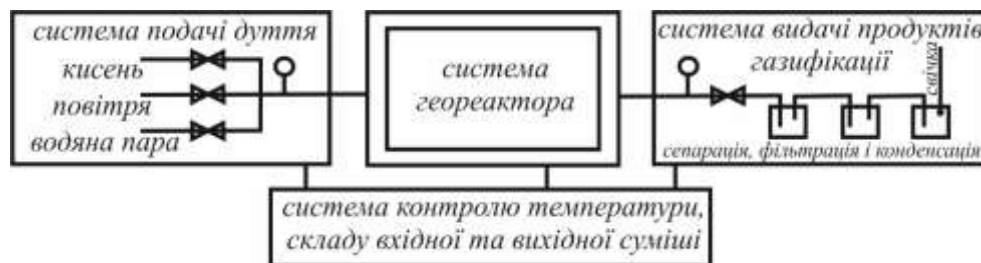
Рисунок 1 - Технологічна схема стендової установки підземної газифікації вугілля
