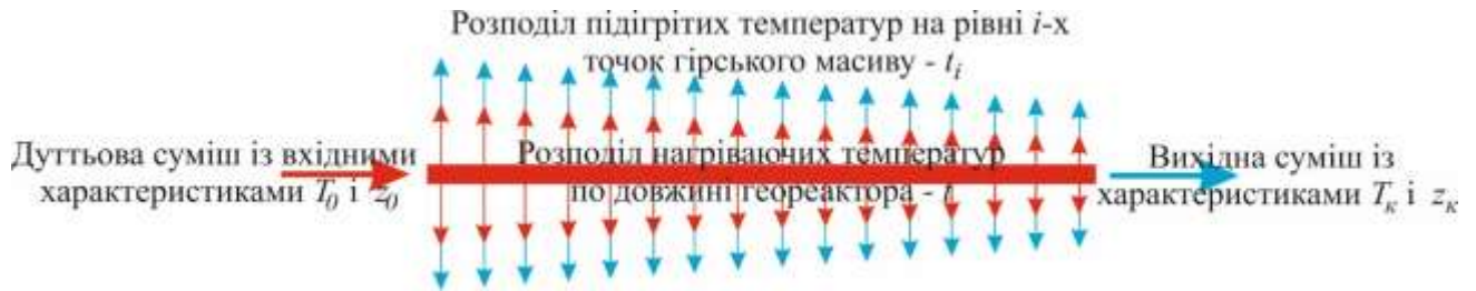
Рисунок 5 - Розрахункова схема теплообміну в межах зони впливу підвищених температур від геореактора: T_0 , z_0 , T_k , z_k – відповідно вхідні та вихідні значення температур та дуттьового еквіваленту
