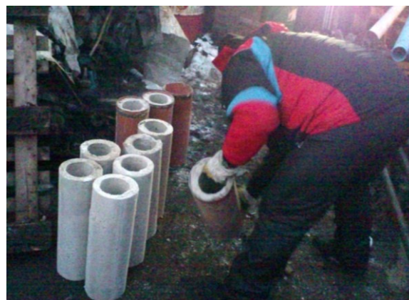
Рис. 4. Извлечение опытных образцов КГЭ из форм
