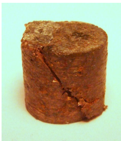
Рис. 4. Характерный вид разрушения образцов при одноосном сжатии
