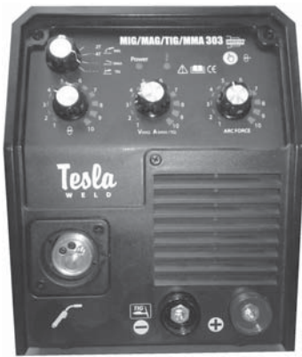
Рис. 8. Зовнішній вигляд передньої панелі (панелі керування) зварювального джерела живлення інверторного типу MIG/MAG/TIG/MMA 303
