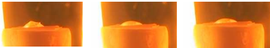
Рис. 4. Змочування підкладки із нікелю сріблом в атмосфері \text{CO}_2 (0,01—0,001 МПа): a — 960 °С, початок плавлення; б — 980 °С, \theta = 37^\circ ; в — 1010 °С, \theta = 34^\circ
