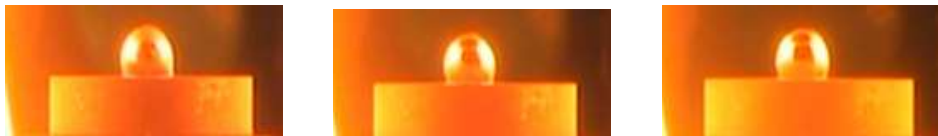
Рис. 5. Змочування підкладки із сталі 45 припоем ПСР-72 в атмосфері \text{CO}_2 (0,01—0,001 МПа): a — 820 °С, \theta = 95^\circ ; б — 850 °С, \theta = 105^\circ ; в — 930 °С, \theta = 105^\circ
