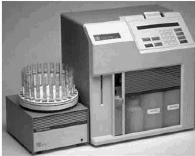
Рис. 3. Перший комерційний глюкометр, розроблений компанією Yellow Springs Instruments
