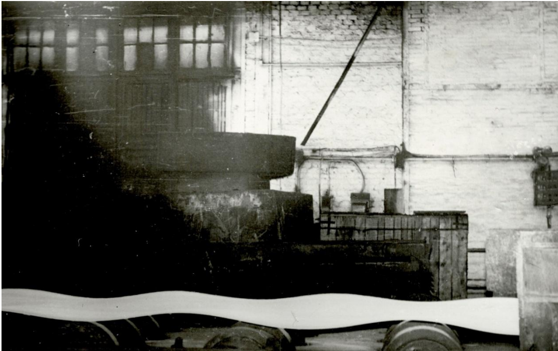
Рис. 1. Одна из масштабных фотографий неплоскостной полосы, которые использовались для исследований связи параметров коробления с параметрами прокатки
