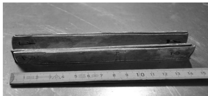
Рис. 2. Подготовленные к прокатке пакеты биметаллических алюминиево-стальных полос
