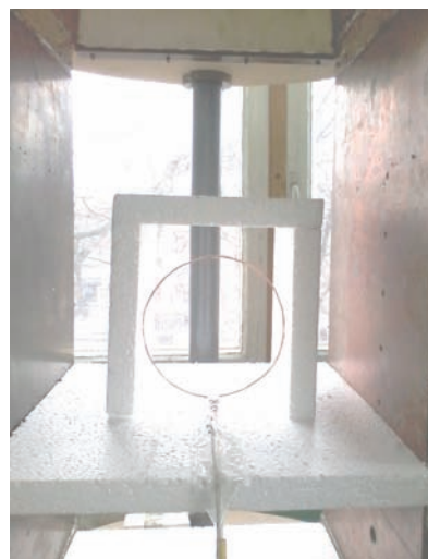
Рис. 11. Исследуемая приемная антенна в центре TEM -камеры
