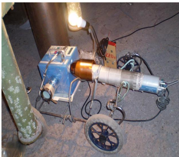
Рис. 1. Пробоотборный комплекс в помещении 012/7 объекта «Укрытие».
