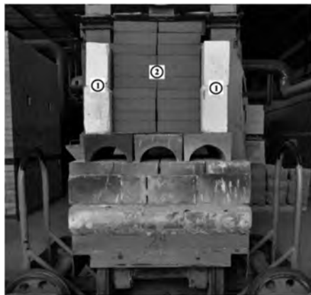
Рис.1. Вариант садки огнеупорных изделий с муфелем: 1 — муфель; 2 — пакет изделий.
