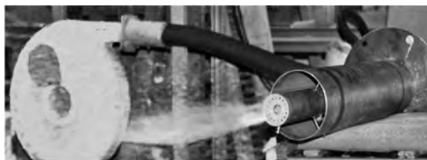
Рис.2. Скоростная горелка ГНБ-80 в установочной обойме.
