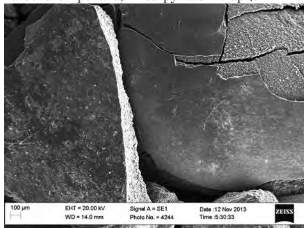
Рис.4. Пироуглерод, осажденный на термопаре (увеличение в 100 раз, полученное растровым электронным микроскопом ZEISS EVO SO).
