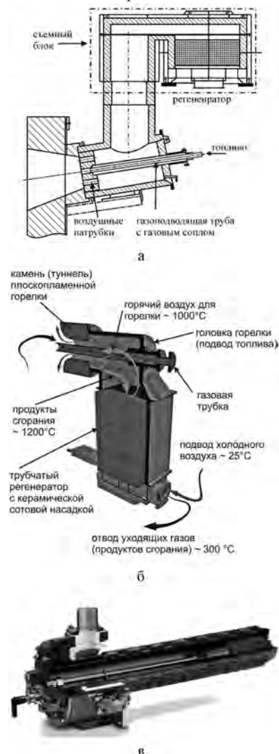
Рис.8. Горелки – утилизаторы теплоты: регенеративная горелка фирмы «Bloom Engineering» [24] (а); регенеративная плоскопламенная горелка, разработанная совместно с фирмой «Elster Kromschroeder» [21, 22] (б); рекуперативная горелка типа ECOMAX [5, 6] (в).
