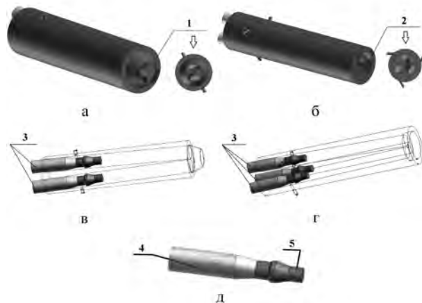
Рис.1. Высоковольтные плазмотроны переменного тока и электродные узлы: а – однофазный двухканальный плазмотрон; б – однофазный трехканальный плазмотрон; в – однофазный двухканальный плазмотрон в сборке с электродными узлами; г – трехфазный трехканальный плазмотрон в сборке с электродными узлами; д – стержневой электрод.
