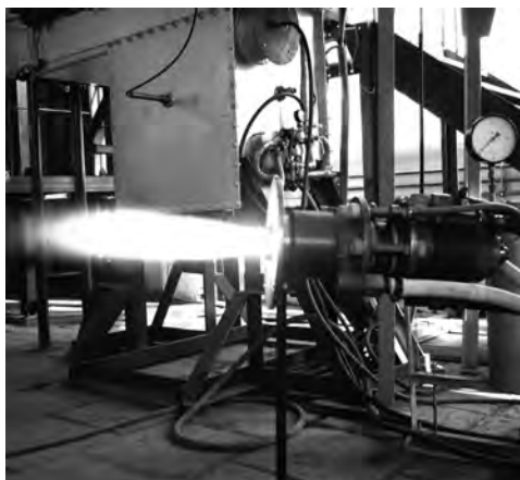
Рис.6. Пароводяной плазмотрон в процессе наладки оборудования.
