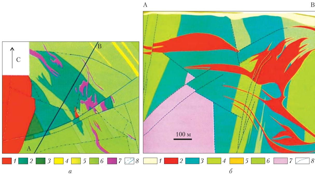
**Рис. 3.** Крупномасштабная схема геологического строения (а) и геологический разрез по линии А – В (б) месторождения “Балка Крутая” [4]. 1 – тоналиты и плагиограниты шевченковского комплекса; 2 – ультрабазиты; 3 – метабазиты; 4 – кварциты; 5 – нижняя часть разреза крутобалковской свиты; 6 – верхняя часть разреза крутобалковской свиты; 7 – редкометалльные (с бериллиевой минерализацией) пегматиты; 8 – контакты и структурные линии
