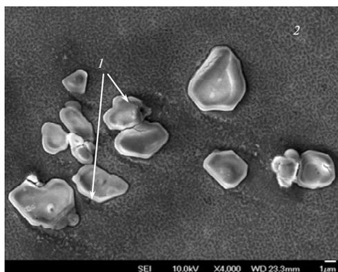
Рис. 6. Структура композиционного материала NiAl–15ZrB<sub>2</sub> после окисления на воздухе при  $T = 1000\text{ }^{\circ}\text{C}$  (время окисления – 1 мин): 1 – зерна ZrB<sub>2</sub>; 2 – интерметаллидная матрица.
