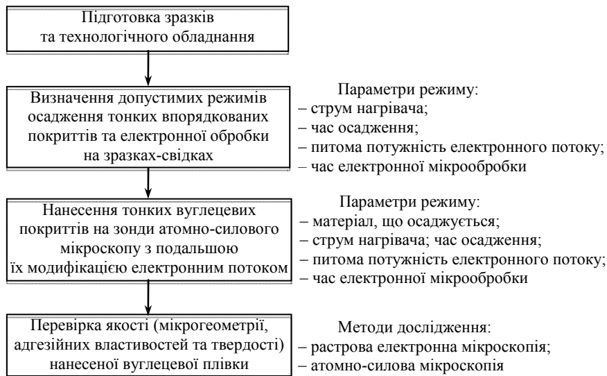
Рис. 1. Послідовність модифікування зондів тонким покриттям.
