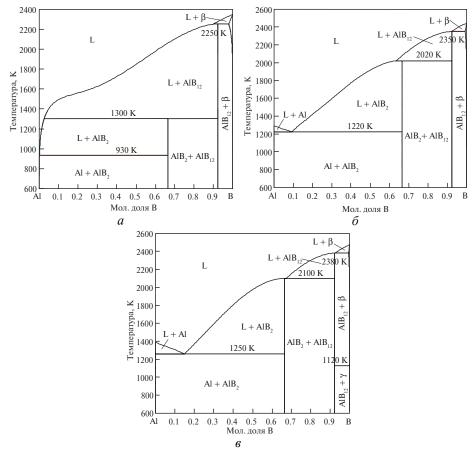
Диаграмма состояния системы Al–B при давлениях 0,1 (a), 6 ( $\delta$ ) и 7,7 (e) ГПа;  $\beta$ ,  $\gamma$  – аллотропы бора ( $\beta$ -B<sub>106</sub>,  $\gamma$ -B<sub>28</sub> соответственно).
