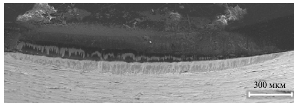
Рис. 6. Вид изношенного участка инструмента с композитом wBN–cBN после 40 с точения с охлаждением; v_p = 180 м/мин, S = 0,05 мм/об.
