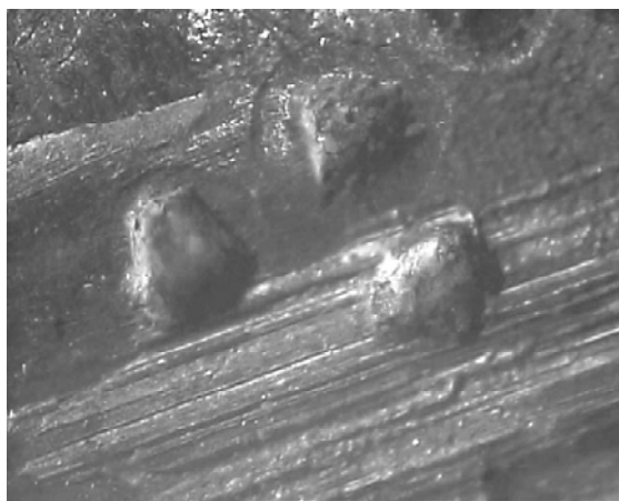
Рис. 7. Поверхность изнашивания электроспеченного композита на основе гранул из алмазов марки АС160Т 599/500 и ВК6 на никелевой связке (оболочка гранул нагревается при трении до температуры, обуславливающей деградацию свойств алмаза).
