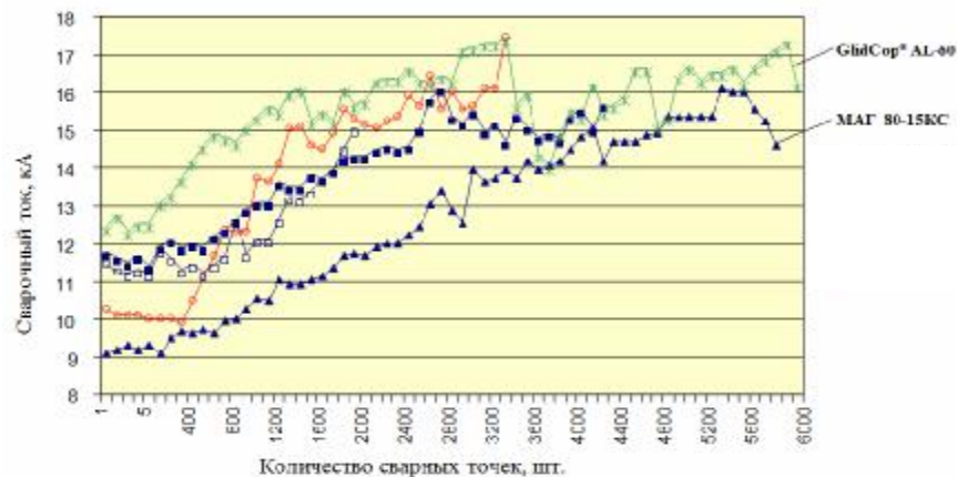
Рис. 1. Циклограмма сравнительных производственных испытаний электродов из различных материалов на основе меди при точечной контактной сварке листовой оцинкованной стали G60: ▲ — МАГ 80-15КС; ○ — CuZr 328; □ — МАГ 40-20К; ■ — МАГ 50-25К; × — GlidCop® AL-60.
