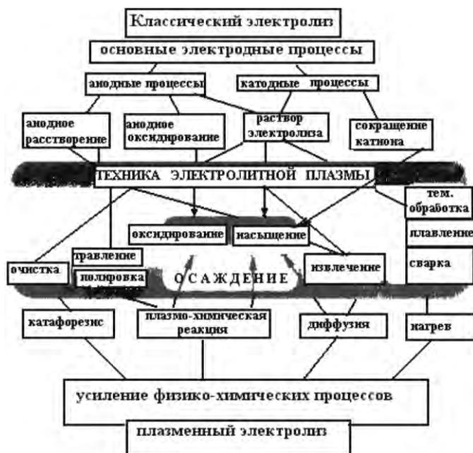
**Рис. 3.** Отношения между физико-химическими процессами, встречающимися в плазменном электролизе и основных электродных процессах классического электролиза в плазменно-электролитной обработке.
