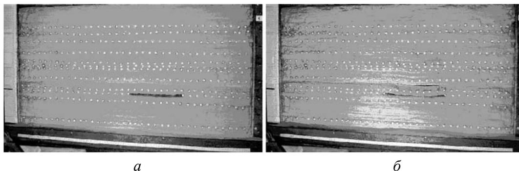
**Рис. 3.** Состояние модели до обрушения кровли (а) и после посадки кровли (б)
