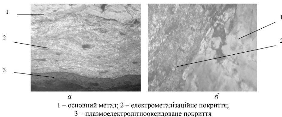
Рис. 7. Мікроструктура травленої області зразка: \times 250 (а); \times 400 (б)
