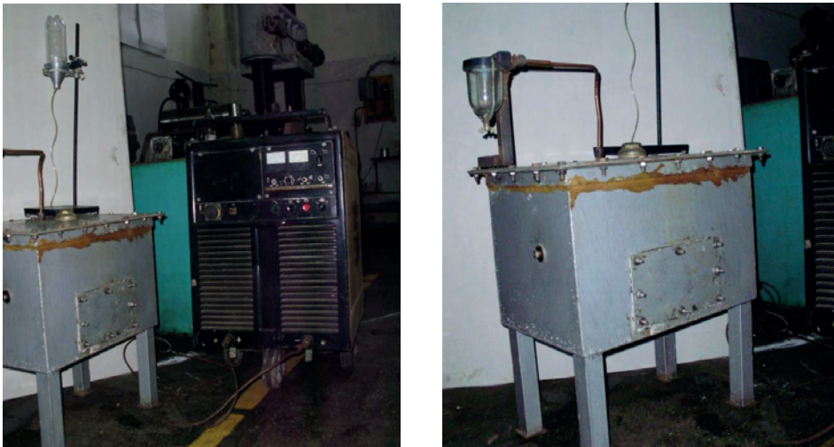
Рис. 4. Експериментальна установка для отримання синтез-газу для відновлення порошків
