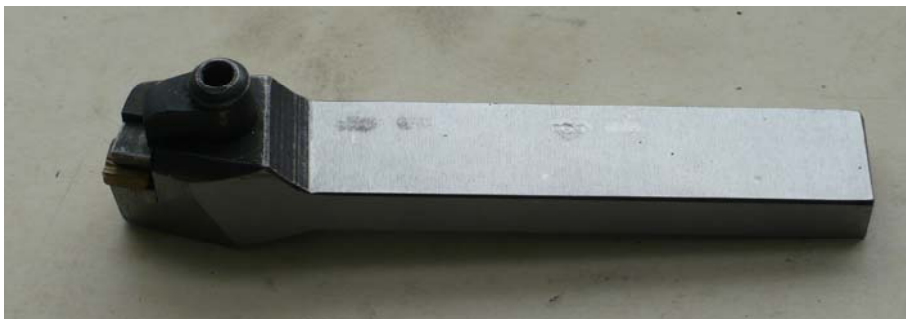
Рис. 3. Загальний вигляд різця з нанокерамічною вставкою
