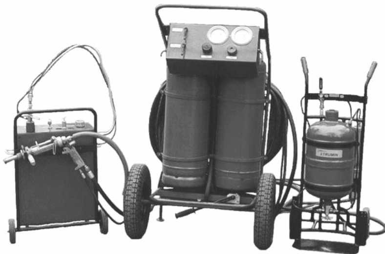
Рис. 5. Установка термоабразивной очистки и напыления антикоррозионных покрытий “Струмінь”
