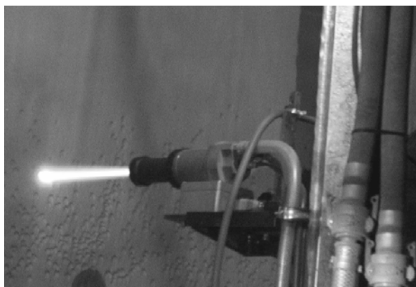
Рис. 4. Высокоскоростное воздушно-топливное напыление колонны адсорбера горелкой SB500 [33]
