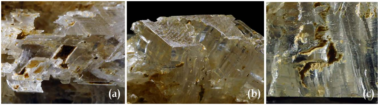
Рис. 13. Элементы расщепленного роста (а, б) и дефекты на гранях (с), связанные с захватом механических примесей (фото О.Я. Червяцовой).
