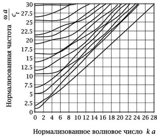
Рис. 4. Расчет дисперсионного спектра для неоднородного ( $\lambda = \ln(2)$ ,  $p = 6$ ) цилиндра из  $Zn^{(\lambda=0, p=0)}$  ( $\alpha = 5\pi/6$ ,  $\tau = 3/5$ ,  $\beta = 0$ )
