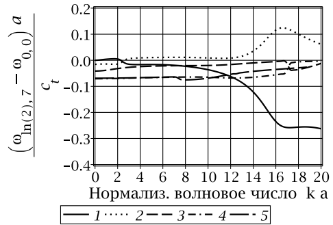
Рис. 4. Сравнительный анализ дисперсионных спектров для однородного и неоднородного (\lambda, q) = (\ln(2), 7) цилиндров.
