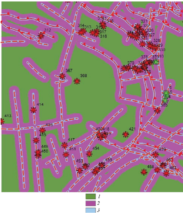
Рис. 3. Растрова модель класифікації відстаней між розломними зонами і зсувними тілами: 1 – зона максимального віддалення до розломів; 2 – зона середнього наближення до розломів; 3 – зона максимального наближення до розломів. Решту умовних позначень зсувів див. на рис. 1
