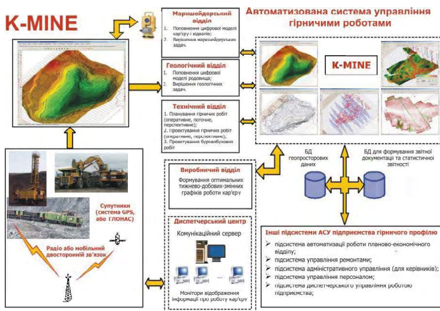
Рис. 1. Структура автоматизованої системи управління гірничими роботами для підприємства з відкритим способом видобутку
