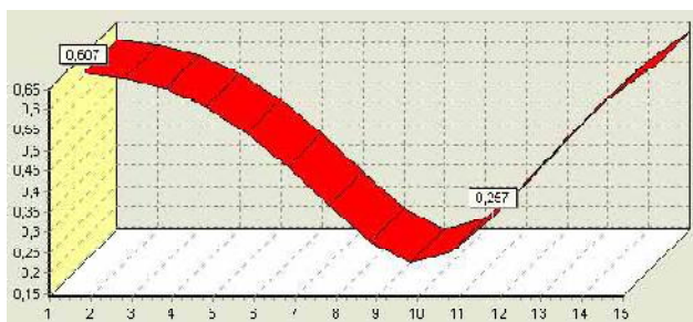
Рис. 4. Зміна інтенсивності напружень з боку середовища по контуру труби
