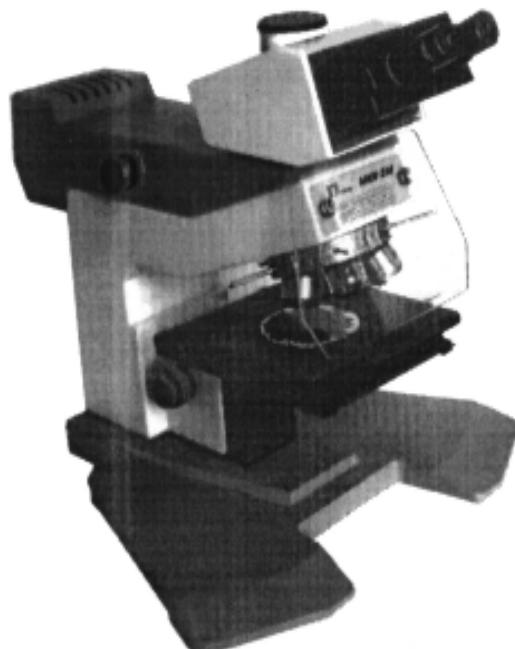
Предназначен для использования в технологическом процессе при производстве изделий электронной техники для контроля дефектов структур интегральных микросхем на фотошаблонах и полупроводниковых пластинах.
