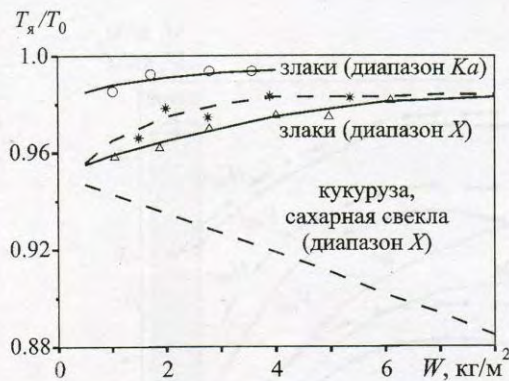
Рис. 5. Зависимости нормированной яркостной температуры T_{я}/T_0 от поверхностной плотности запасенной влаги W для разных культур и диапазонов радиоволн ( X -, Ka -): о — данные авторов, остальные данные взяты из [16]
