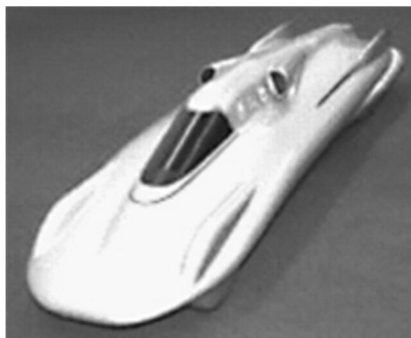
Макет англійського парового автомобіля Inspiration. Його конструктори переконані у тому, що найближчим часом перевищать швидкісну межу в 320 км/год
